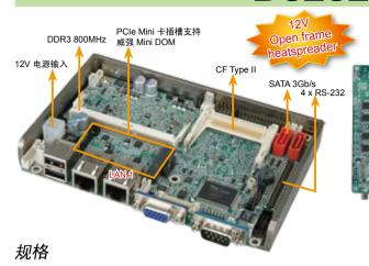
Intel® Atom™ D525 Dual-core 处理器 1.8GHz / 1MB L2 缓存 Intel® Atom™ D425 Single-core 处理器 1.8GHz / 512KB L2 缓存 Intel® Atom™ N455 Single-core 处理器 1.6GGHz / 512KB L2 缓存
